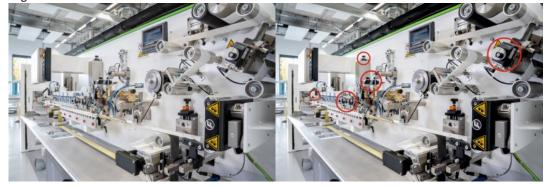
Fig. 2) e 3) Dal laminato plastico al tubo finito: il FlexSeamer è facile da usare e sicuro grazie alla regolazione del formato monitorata da SIKO (marcature). Figure: © PackSys Global
