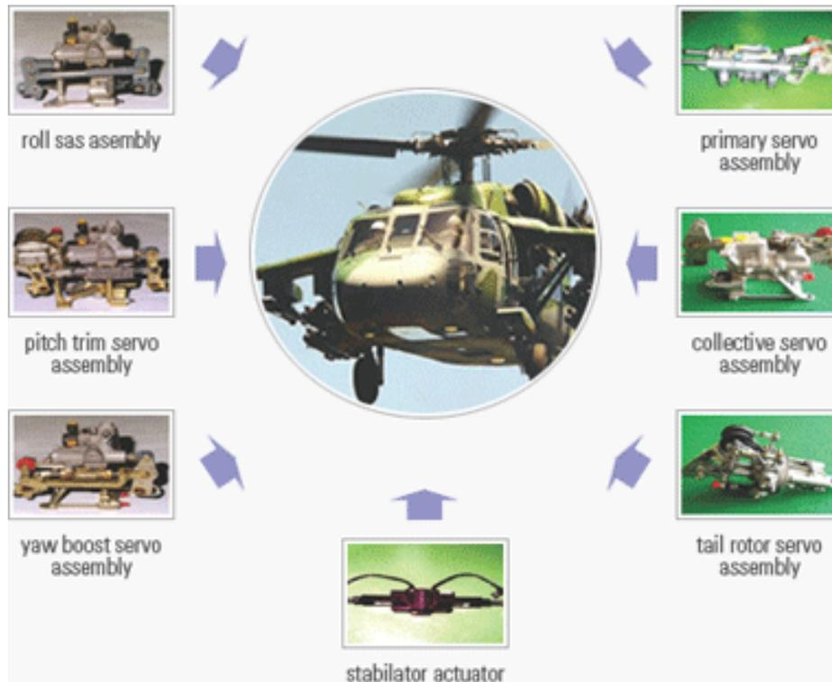
Fig.1.9 Attuatori idraulici in un elicottero, [W9]
